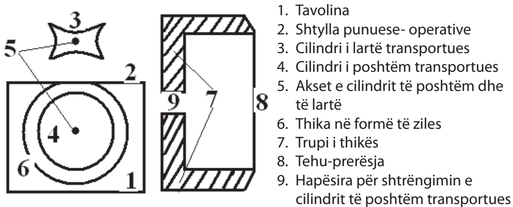
Figura 47. Skema e makinës për hollim anësor
